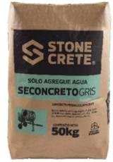
Es un **concreto estructural clase 2**, diseñado para el colado de elementos estructurales, columnas, trabes, losas, castillos, cadenas, dalas y otros elementos como pisos, firmes y guarniciones, fabricado con Cemento CPC-40, grava cribada de 3/8", arena de granulometría controlada y aditivos de calidad, previamente dosificados y mezclados en seco para ser envasado en planta.
