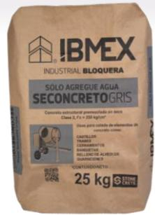
Es un **concreto estructural clase 2**, diseñado para el colado de elementos estructurales, columnas, trabes, losas, castillos, cadenas, dalas y otros elementos como pisos, firmes y guarniciones, fabricado con Cemento CPC-40, grava cribada de 3/8", arena de granulometría controlada y aditivos de calidad, previamente dosificados y mezclados en seco para ser envasado en planta.
